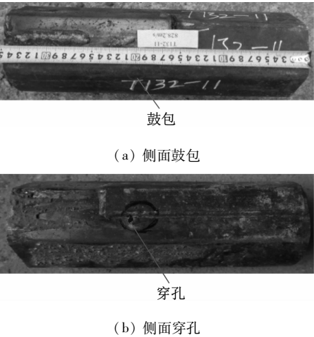
图 5 钢管侧面鼓包和穿孔
